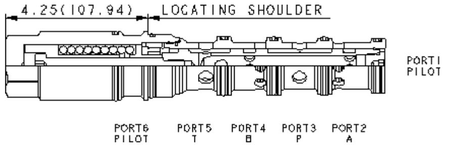
Dieses Ventil ist ein 4/3-Wegeventil. Es arbeitet als Proportionaldrossel. Die Anschlüsse 2 und 4 sind in Mittelstellung entlastet nach 5, Anschluss 3 ist geschlossen. Steuerdruck an Anschluss 1 wirkt gegen die Feder und erzeugt eine Drosselstelle zwischen Anschluss 3 und 4, die proportional zum Druck an 1 ist. Steuerdruck an Anschluss 6 öffnet 3 nach 2. Das Ventil ist teilweise selbstkompensierend. Die Drücke an den Anschlüssen 1 und 6 wirken einander direkt entgegen.
