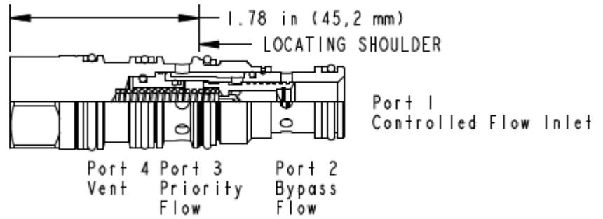
Entlastbare Vorzugsstromregelventile mit fest eingestellter Blende regeln den Volumenstrom von Anschluss 1 nach 3. Überschüssiger Volumenstrom wird aus Anschluss 2 abgeleitet. Das Ventil ist reststrombelastbar. Über den Entlastungsanschluss 4 kann das Ventil extern angesteuert werden.
