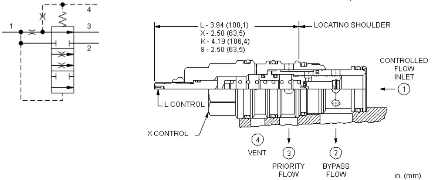
Entlastbare Vorzugsstromregelventile mit fest eingestellter Blende regeln den Volumenstrom von Anschluss 1 nach 3. Überschüssiger Volumstrom wird aus Anschluss 2 abgeleitet. Das Ventil ist reststrombelastbar. Über den Entlastungsanschluss 4 kann das Ventil extern angesteuert werden.
