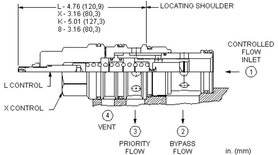
Entlastbare Vorzugsstromregelventile mit fest eingestellter Blende regeln den Volumenstrom von Anschluss 1 nach 3. Überschüssiger Volumenstrom wird aus Anschluss 2 abgeleitet. Das Ventil ist reststrombelastbar. Über den Entlastungsanschluss 4 kann das Ventil extern angesteuert werden.
