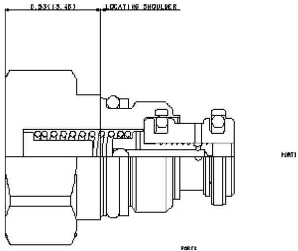
Fest eingestellter 2-Wege Stromregler zur genauen Einstellung von druckunabhängigen Volumenströmen bei Zulauf- und Ablaufregelung. Der Volumenstrom wird werkseitig über eine Blende auf den vorgegebenen Wert eingestellt. Es können verschiedene Einstellungen ausgewählt werden.
