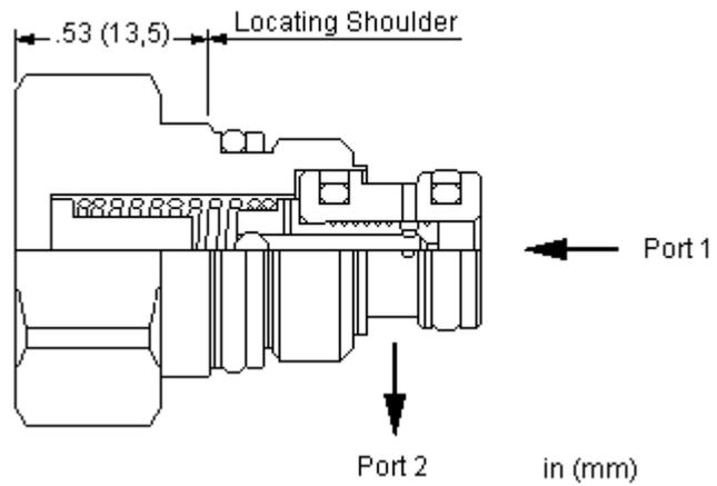
Fest eingestellter 2-Wege Stromregler zur genauen Einstellung von druckunabhängigen Volumenströmen bei Zulauf- und Ablaufregelung. Der Volumenstrom wird werkseitig über eine Blende auf den vorgegebenen Wert eingestellt. Es können verschiedene Einstellungen ausgewählt werden.
