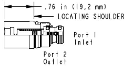
Les régulateurs de débit compensés en pression à orifice fixe, fonctionnent en entrée ou en sortie de récepteur et assurent une régulation précise du débit même en cas d'importantes fluctuations de la pression. Différents débits sont disponibles.
