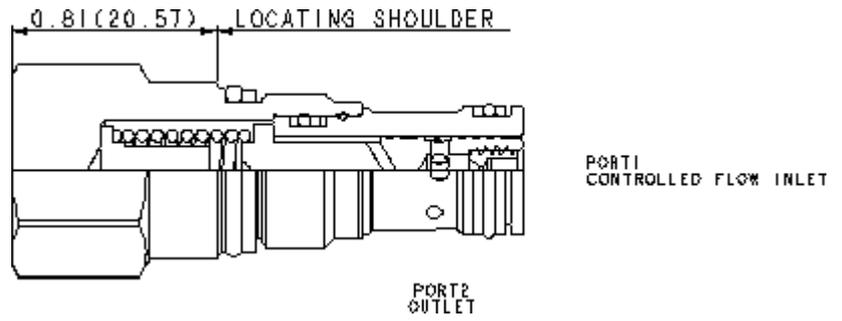
Les régulateurs de débit compensés en pression à orifice fixe, fonctionnent en entrée ou en sortie de récepteur et assurent une régulation précise du débit même en cas d'importantes fluctuations de la pression. Le débit requis
