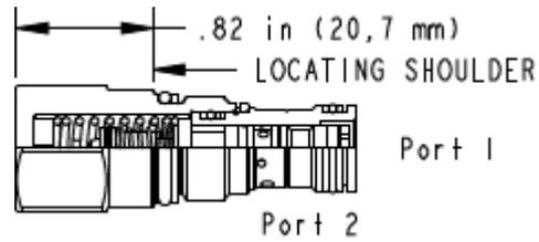
Les régulateurs de débit compensés en pression à orifice fixe, fonctionnent en entrée ou en sortie de récepteur et assurent une régulation précise du débit même en cas d'importantes fluctuations de la pression. Le débit requis doit être spécifié par le client et le réglage est fait en usine.
