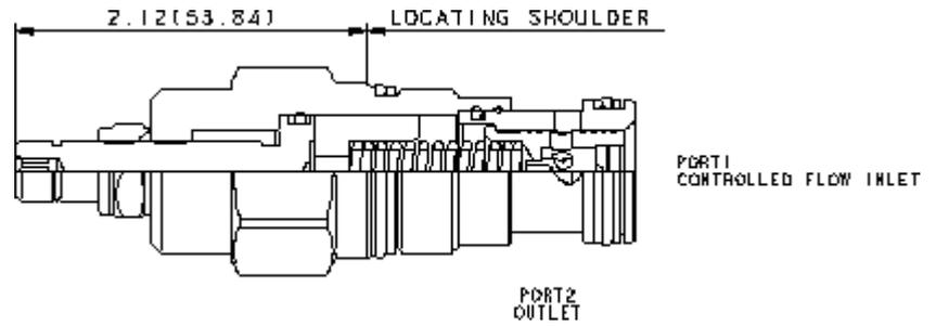
Les régulateurs de débit compensés en pression à orifice fixe, fonctionnent en entrée ou en sortie de récepteur et assurent une régulation précise du débit même en cas d'importantes fluctuations de la pression. Le débit requis doit être spécifié par le client et le réglage est fait en usine.
