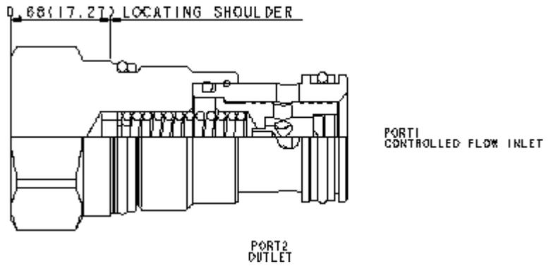
Fest eingestellter 2-Wege Stromregler zur genauen Einstellung von druckunabhängigen Volumenströmen bei Zulauf- oder Ablaufregelung. Der Volumenstrom wird werkseitig über eine Blende auf den vorgegebenen Wert eingestellt.
