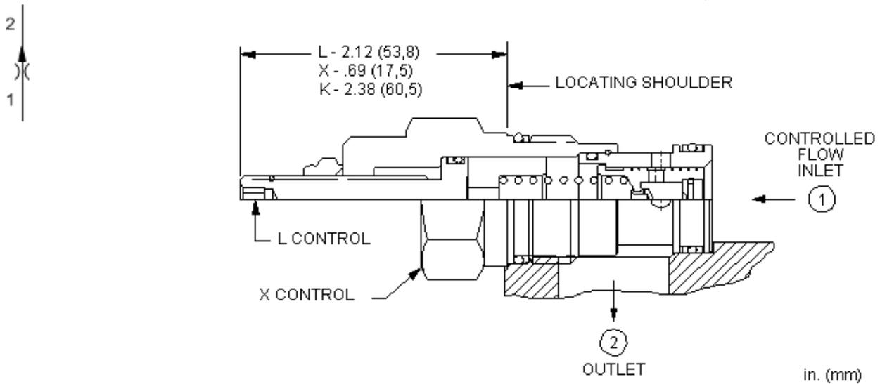
Fest eingestellter 2-Wege Stromregler zur genauen Einstellung von druckunabhängigen Volumenströmen bei Zulauf- oder Ablaufregelung. Der Volumenstrom wird werkseitig über eine Blende auf den vorgegebenen Wert eingestellt.
