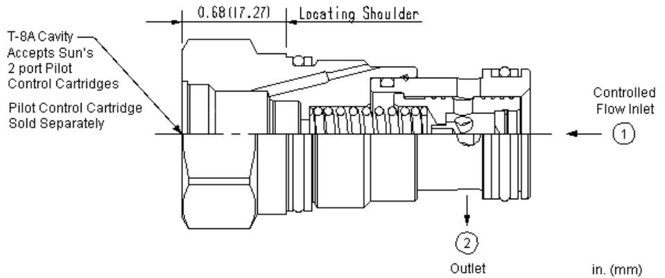
Fest eingestellter 2-Wege Stromregler für genaue Einstellung von druckunabhängigen Volumenströmen bei Zulauf- und Ablaufregelung. Die Volumenstromregelung kann über ein in die T-8A Einschraubbohrung eingebautes Pilotventil zu- oder abgeschaltet werden. Der Volumenstrom wird werkseitig über eine Blende auf den vorgegebenen Wert eingestellt.
