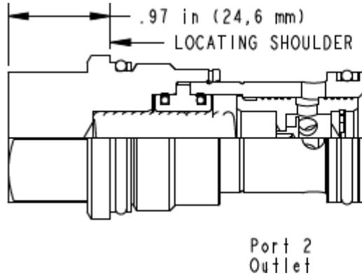
Les régulateurs de débit compensés en pression à orifice fixe, fonctionnent en entrée ou en sortie de récepteur et assurent une régulation précise du débit même en cas d'importantes fluctuations de la pression. Le débit requis doit être spécifié par le client et le réglage est fait en usine.
