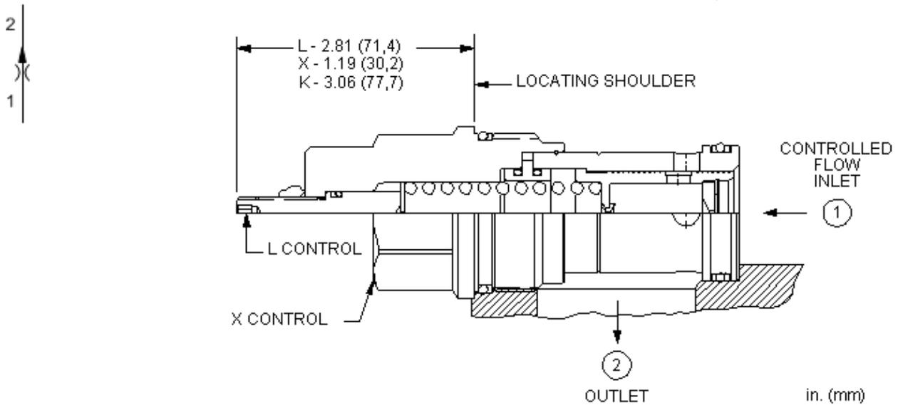
Fest eingestellter 2-Wege Stromregler zur genauen Einstellung von druckunabhängigen Volumenströmen bei Zulauf- oder Ablaufregelung. Der Volumenstrom wird werkseitig über eine Blende auf den vorgegebenen Wert eingestellt.
