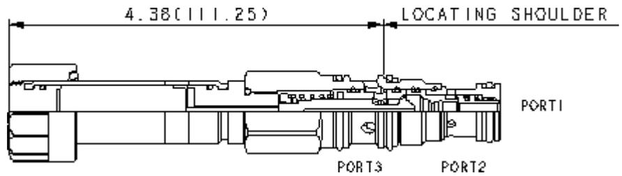
Dieses Hybridventil ist eine Kombination aus einem magnetbetätigten 2/2-Wege-Sitzventil und einem Rückschlagventil. Das Rückschlagventil wird von Anschluss 2 nach 1 durchströmt. In Ruhestellung des Magnetventils ist der Durchfluss von Anschluss 2 nach 3 gesperrt. Das Hybridventil wird typischerweise in Hub-Senksteuerungen verwendet und kann direkt am Stellantrieb montiert werden.
