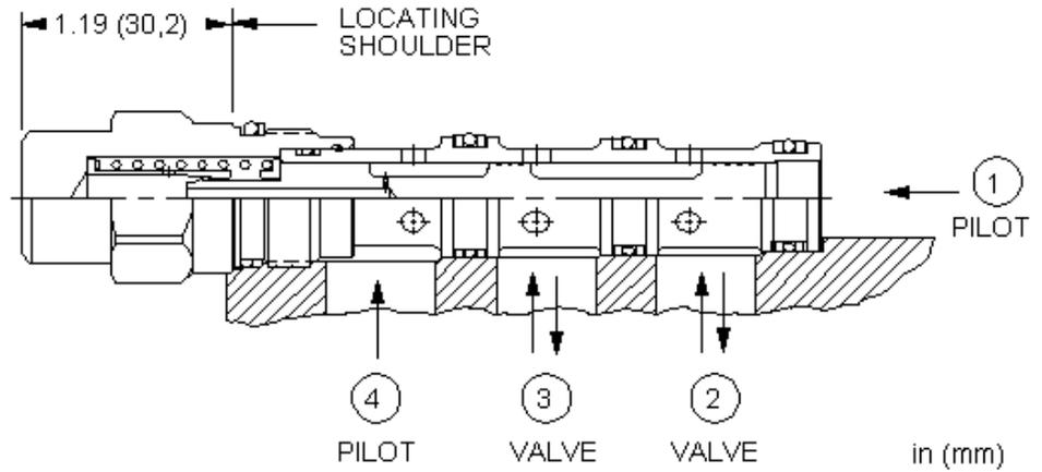
Diese bidirektionale Druckwaage ist in der Ruhestellung geöffnet und regelt den Volumenstrom durch eine externe Blende in beide Richtungen.
