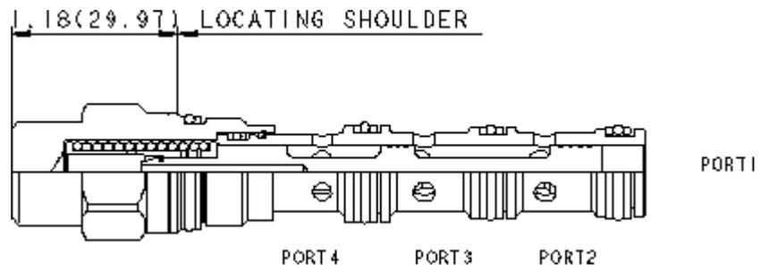
Ces éléments de régulation bidirectionnels, normalement ouverts, utilisés avec un gicleur externe constituent un régulateur de débit compensé bidirectionnel.
