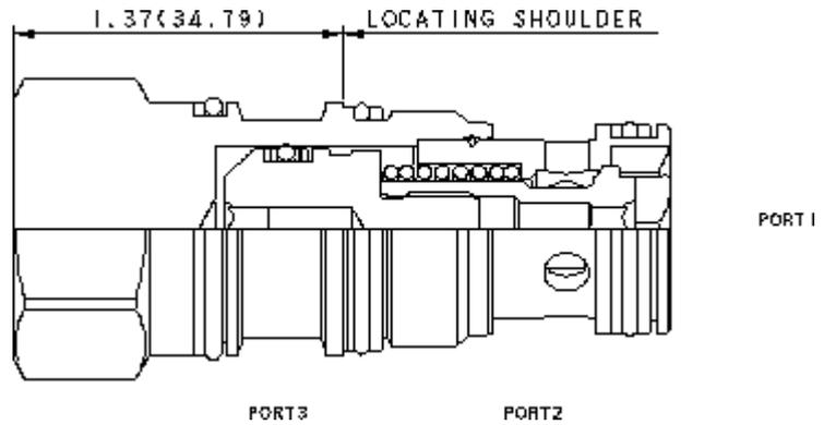
Dieses entsperrbare, nicht druckausgeglichene und in Ruhestellung geschlossene 2/2-Wege Schaltelement wird über Anschluss 3 angesteuert. Steuerdruck an Anschluss 3 öffnet das Ventil gegen die Federkraft. Hinweis: Die Fläche an Anschluss 3 ist 1.8 mal größer als die Fläche von Anschluss 1 und 2.25 mal größer als an Anschluss 2. Der Druck an Anschluss 3 muss entsprechend über der Federkraft und dem Druck an Anschluss 1 und 2 liegen, um den Kolben zu öffnen.
