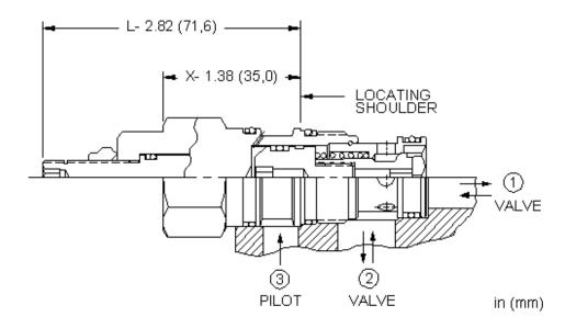
Dieses entsperrbare, nicht druckausgeglichene und in Ruhestellung geschlossene 2/2-Wege Schaltelement wird über Anschluss 3 angesteuert. Steuerdruck an Anschluss 3 öffnet das Ventil gegen die Federkraft. Hinweis: Die Fläche an Anschluss 3 ist 1.8 mal größer als die Fläche von Anschluss 1 und 2.25 mal größer als an Anschluss 2. Der Druck an Anschluss 3 muss entsprechend über der Federkraft und dem Druck an Anschluss 1 und 2 liegen, um den Kolben zu öffnen.
