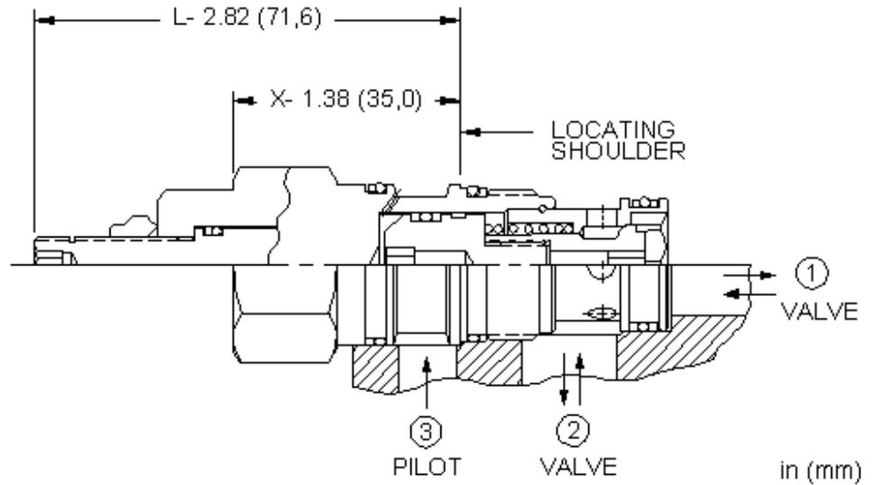
Dieses entsperrbare, nicht druckausgeglichene und in Ruhestellung geschlossene 2/2-Wege Schaltelement wird über Anschluss 3 angesteuert. Steuerdruck an Anschluss 3 öffnet das Ventil gegen die Federkraft. Hinweis: Die Fläche an Anschluss 3 ist 1.8 mal größer als die Fläche von Anschluss 1 und 2.25 mal größer als an Anschluss 2. Der Druck an Anschluss 3 muss entsprechend über der Federkraft und dem Druck an Anschluss 1 und 2 liegen, um den Kolben zu öffnen.
