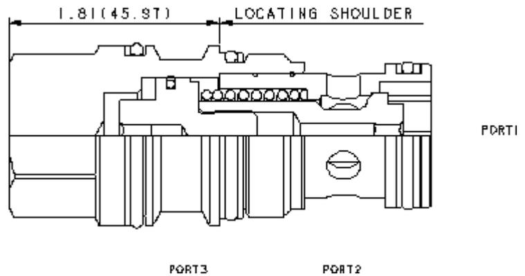
Dieses entsperbare, nicht druckausgeglichene und in Ruhestellung geschlossene 2/2-Wege Schaltelement wird über Anschluss 3 angesteuert. Steuerdruck an Anschluss 3 öffnet das Ventil gegen die Federkraft. Hinweis: Die Fläche an Anschluss 3 ist 1.8 mal größer als die Fläche von Anschluss 1 und 2.25 mal größer als an Anschluss 2. Der Druck an Anschluss 3 muss entsprechend über der Federkraft und dem Druck an Anschluss 1 und 2 liegen, um den Kolben zu öffnen.
