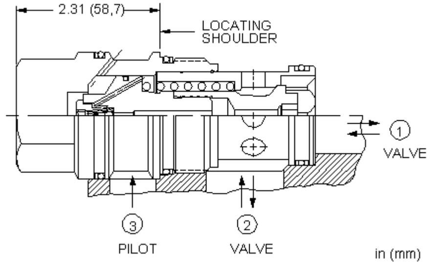
Dieses entsperbare, nicht druckausgeglichene und in Ruhestellung geschlossene 2/2-Wege Schaltelement wird über Anschluss 3 angesteuert. Steuerdruck an Anschluss 3 öffnet das Ventil gegen die Federkraft. Hinweis: Die Fläche an Anschluss 3 ist 1.8 mal größer als die Fläche von Anschluss 1 und 2.25 mal größer als an Anschluss 2. Der Druck an Anschluss 3 muss entsprechend über der Federkraft und dem Druck an Anschluss 1 und 2 liegen, um den Kolben zu öffnen.
