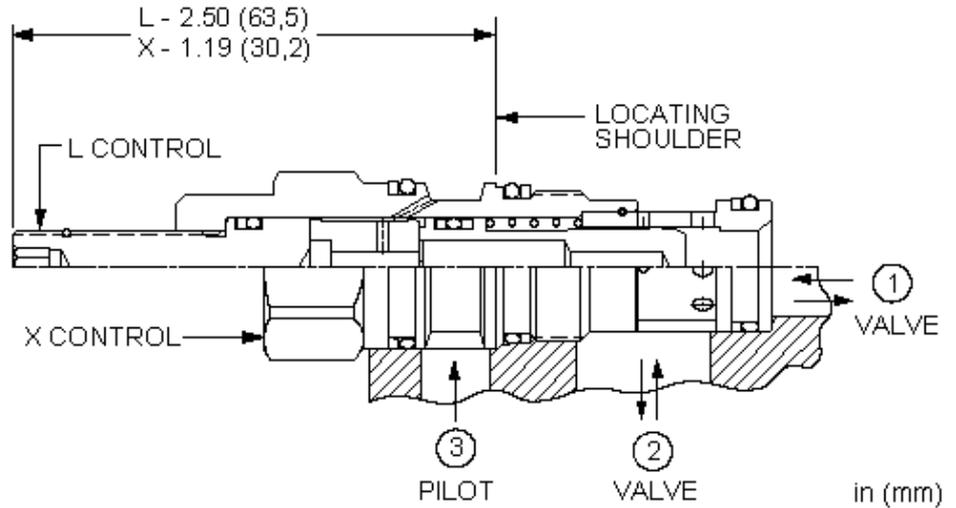
Dieses sperrbare, nicht druckausgeglichene und in Ruhestellung geöffnete Schaltelement wird über Anschluss 3 angesteuert. Druck an Anschluss 1 oder 2 wirkt öffnend auf das Ventil, Druck an Anschluss 3 wirkt schließend. Der Druck an Anschluss 3 muss entsprechend über der Federkraft und dem Druck an Anschluss 1 und 2 liegen, um den Kolben geschlossen zu halten. Hinweis: Die Fläche an Anschluss 3 ist 1.8 mal größer als die Fläche an Anschluss 1, und 2.25 mal größer als an Anschluss 2.
