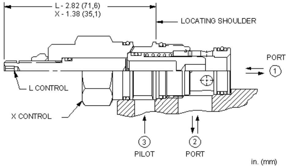
Dieses sperrbare, nicht druckausgeglichene und in Ruhestellung geöffnete Schaltelement wird über Anschluss 3 angesteuert. Druck an Anschluss 1 oder 2 wirkt öffnend auf das Ventil, Druck an Anschluss 3 wirkt schließend. Der Druck an Anschluss 3 muss entsprechend über der Federkraft und dem Druck an Anschluss 1 und 2 liegen, um den Kolben geschlossen zu halten. Hinweis: Die Fläche an Anschluss 3 ist 1.8 mal größer als die Fläche an Anschluss 1, und 2.25 mal größer als an Anschluss 2.
