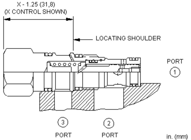
Dieses in Ruhestellung geöffnete Regelement ohne interne Blende kann als 2-Wege-Druckwaage eingesetzt werden, mit der ein Delta P über eine Blende konstant gehalten wird, unabhängig von Druckschwankungen vor dem Ventil und hinter der Blende.
