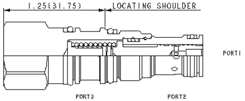
Cet élément de régulation normalement ouvert est spécifiquement prévu pour fonctionner avec les conjoncteurs disjoncteurs de pilotage Sun pour adoucir la décharge de la pompe .
