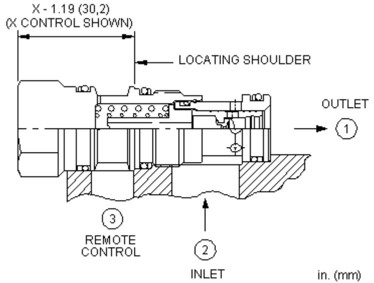
Dieses in Ruhestellung geöffnete Regelement mit interner Verbindung von Anschluss 1 nach 3 kann als Hauptstufe eines 2-Wege-Druckregelventils eingesetzt werden. Dieses Ventil ist mit einem Vorsteuerdruckbegrenzungs- oder Magnetventil fernsteuerbar.
