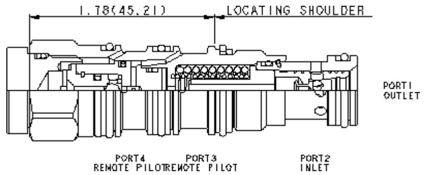
Un élément de régulation normalement ouvert utilisé comme balance de pression à 2 voies maintient une différence de pression constante à travers un étranglement externe et crée un régulateur de débit compensé en pression. Le débit reste constant quelque soient les variations de pression en amont ou en aval. Un sélecteur de circuit à bille relie la plus haute des pression aux orifices 3 et 4 à la section de pilotage.
