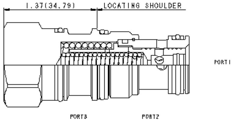
Ces éléments de régulation normalement ouverts avec un gicleur interne entre les chambres 1 et 3 peuvent être utilisés comme étage principal d'un réducteur de pression. La valve peut être pilotée à distance au moyen d'un limiteur de pression pilote ou d'une électrovalve pilote.
