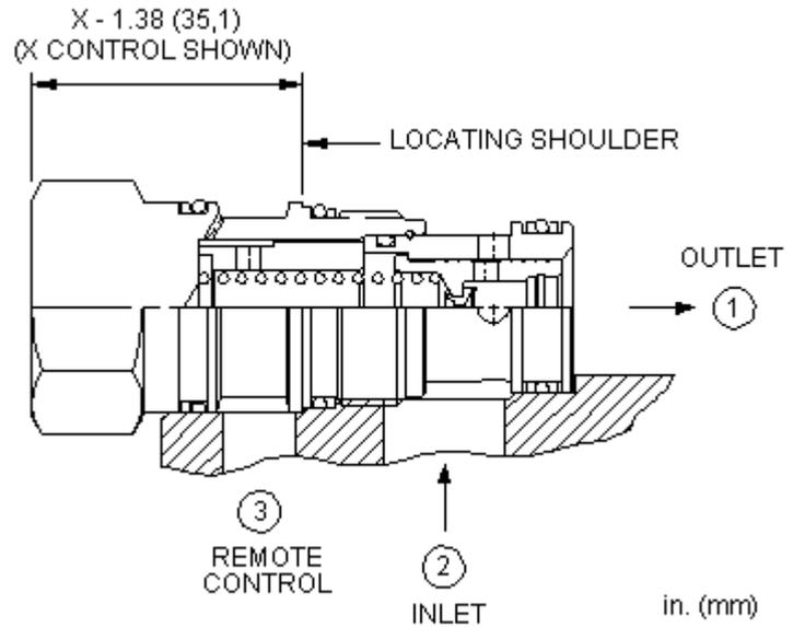
Ces éléments de régulation normalement ouverts avec un gicleur interne entre les chambres 1 et 3 peuvent être utilisés comme étage principal d'un réducteur de pression. La valve peut être pilotée à distance au moyen d'un limiteur de pression pilote ou d'une électrovalve pilote.
