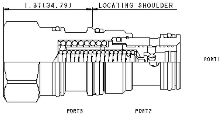
Dieses in Ruhestellung geöffnete Regелеlement ohne interne Blende kann als 2-Wege-Druckwaage eingesetzt werden, mit der ein Delta P über eine Blende konstant gehalten wird, unabhängig von Druckschwankungen vor dem Ventil und hinter der Blende.
