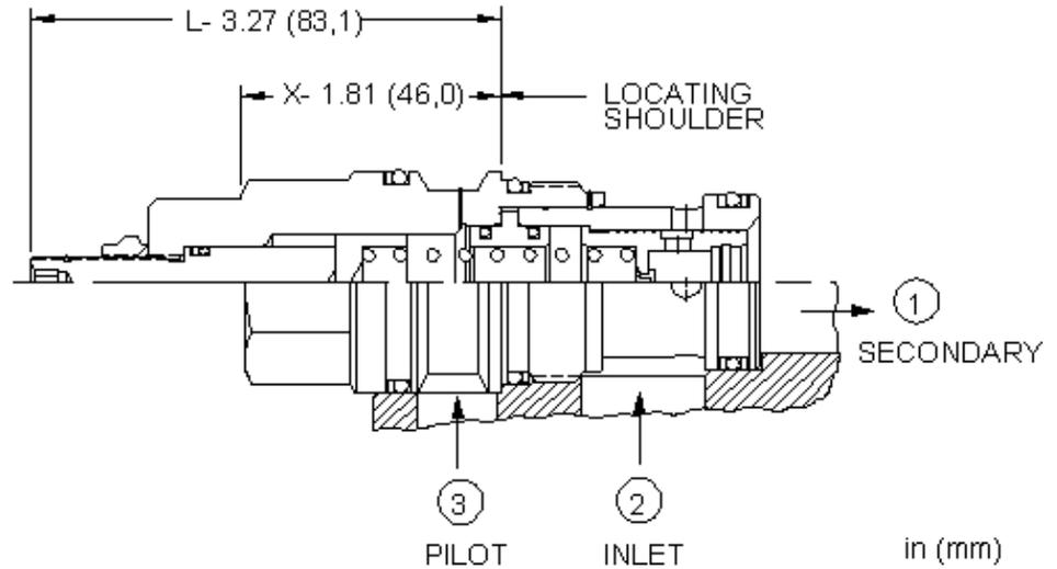
Dieses in Ruhestellung geöffnete Regelement ohne interne Blende kann als 2-Wege-Druckwaage eingesetzt werden, mit der ein Delta P über eine Blende konstant gehalten wird, unabhängig von Druckschwankungen vor dem Ventil und hinter der Blende.
