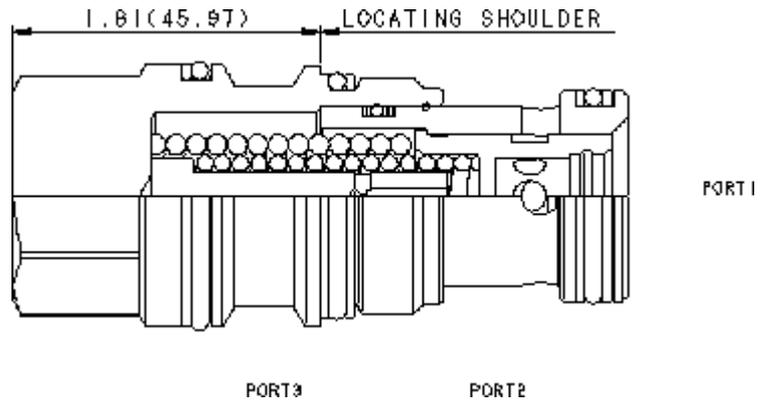
Dieses in Ruhestellung geöffnete Regelement ohne interne Blende kann als 2-Wege-Druckwaage eingesetzt werden, mit der ein Delta P über eine Blende konstant gehalten wird, unabhängig von Druckschwankungen vor dem Ventil und hinter der Blende.
