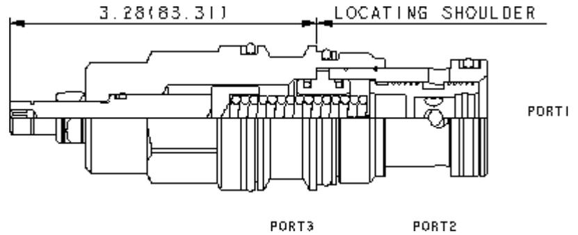
Cet élément de régulation normalement ouvert sans gicleur interne est utilisé comme compensateur 2 voies pour maintenir une différence de pression constante à travers un étranglement, quelles que soient les variations de pression en amont ou en aval .
