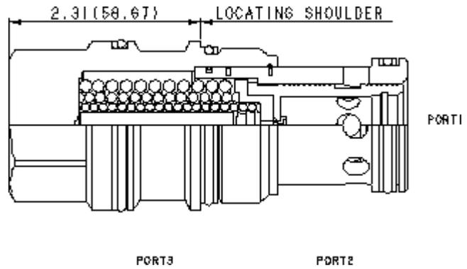
Dieses in Ruhestellung geöffnete Regелеlement mit interner Verbindung von Anschluss 1 nach 3 kann als Hauptstufe eines 2-Wege-Druckregelventils eingesetzt werden. Dieses Ventil ist mit einem Vorsteuerdruckbegrenzungs- oder Magnetventil fernsteuerbar.
