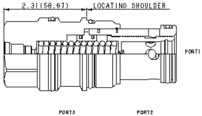
Dieses in Ruhestellung geöffnete Regelement mit interner Verbindung von Anschluss 1 nach 3 kann als Hauptstufe eines 2-Wege-Druckregelventils eingesetzt werden. Dieses Ventil ist mit einem Vorsteuerdruckbegrenzungs- oder Magnetventil fernsteuerbar.
