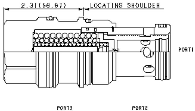
Dieses in Ruhestellung geöffnete Regелеlement ohne interne Blende kann als 2-Wege-Druckwaage eingesetzt werden, mit der ein Delta P über eine Blende konstant gehalten wird, unabhängig von Druckschwankungen vor dem Ventil und hinter der Blende.
