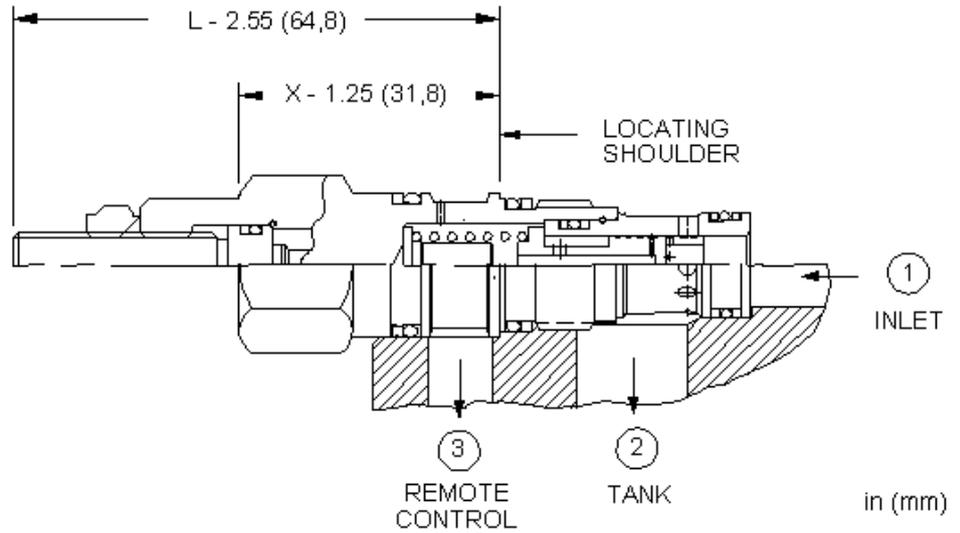
Dieses in Ruhestellung geschlossene Regelement mit interner Verbindung von Anschluss 1 nach 3 kann als Hauptstufe eines Druckbegrenzungsventils eingesetzt werden. Dieses Ventil ist mit einem Vorsteuerdruckbegrenzungs- oder Magnetventil fernsteuerbar.
