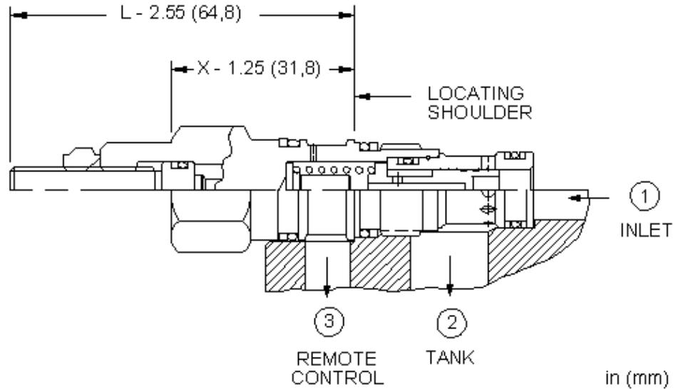
Dieses in Ruhestellung geschlossene Regelement ohne interne Blende hat die Funktion einer 3-Wege-Druckwaage, mit der ein Delta P über eine Blende konstant gehalten wird, unabhängig von Druckschwankungen vor oder nach der Blende.
