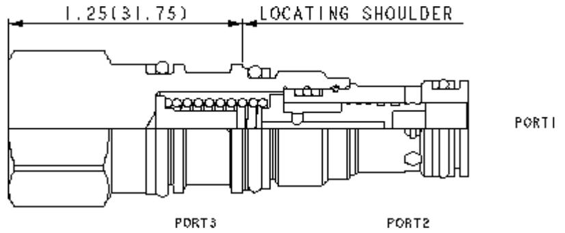
Cet élément de régulation normalement fermé sans gicleur interne est utilisé comme compensateur 3 voies pour maintenir une différence de pression constante à travers un étranglement, quelles que soient les variations de pression en amont ou en aval .
