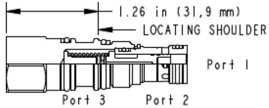
Dieses in Ruhestellung geschlossene Regelement ohne interne Blende hat die Funktion einer 3-Wege-Druckwaage, mit der ein Delta P über eine Blende konstant gehalten wird, unabhängig von Druckschwankungen vor oder nach der Blende.
