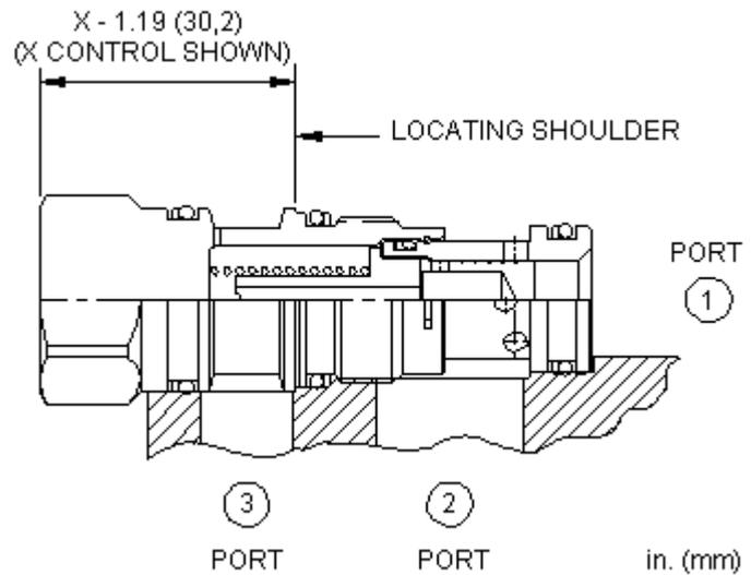
Dieses in Ruhestellung geschlossene Regelement ohne interne Blende hat die Funktion einer 3-Wege-Druckwaage, mit der ein Delta P über eine Blende konstant gehalten wird, unabhängig von Druckschwankungen vor oder nach der Blende.
