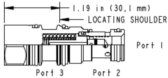
Dieses in Ruhestellung geschlossene Regelement ohne interne Blende hat die Funktion einer 3-Wege-Druckwaage, mit der ein Delta P über eine Blende konstant gehalten wird, unabhängig von Druckschwankungen vor oder nach der Blende.
