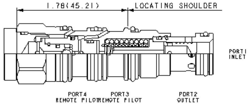
Un élément de régulation normalement fermé utilisé comme balance de pression à 3 voies maintient une différence de pression constante à travers un étranglement externe et crée un régulateur de débit compensé en pression. Le débit reste constant quelque soient les variations de pression en amont ou en aval. Un sélecteur de circuit à bille relie la plus haute des pression aux orifices 3 et 4 à la section de pilotage.
