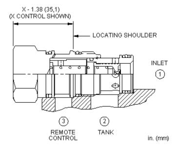
Dieses in Ruhestellung geschlossene Regelelement mit interner Verbindung von Anschluss 1 nach 3 kann als Hauptstufe eines Druckbegrenzungventils eingesetzt werden. Dieses Ventil ist mit einem Vorsteuerdruckbegrenzungs- oder Magnetventil fernsteuerbar.
