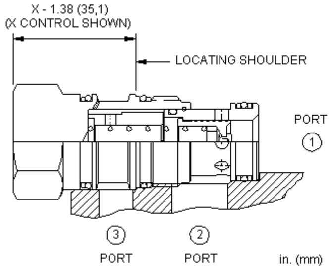
Dieses in Ruhestellung geschlossene Regelement ohne interne Blende hat die Funktion einer 3-Wege-Druckwaage, mit der ein Delta P über eine Blende konstant gehalten wird, unabhängig von Druckschwankungen vor oder nach der Blende.
