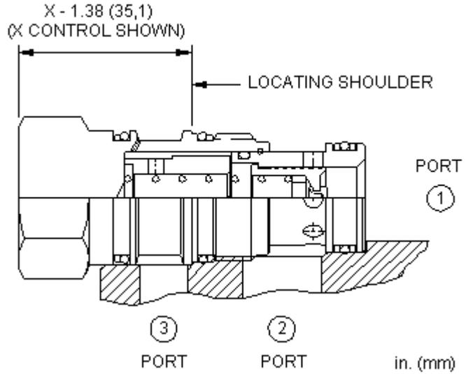
Cet élément de régulation normalement fermé sans gicleur interne est utilisé comme compensateur 3 voies pour maintenir une différence de pression constante à travers un étranglement, quelles que soient les variations de pression en amont ou en aval .
