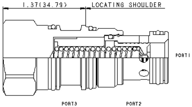
Dieses in Ruhestellung geschlossene Regelement ohne interne Blende hat die Funktion einer 3-Wege-Druckwaage, mit der ein Delta P über eine Blende konstant gehalten wird, unabhängig von Druckschwankungen vor oder nach der Blende.
