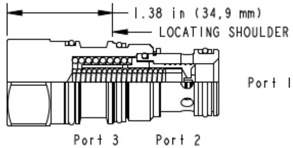
Cet élément de régulation normalement fermé sans gicleur interne est utilisé comme compensateur 3 voies pour maintenir une différence de pression constante à travers un étranglement, quelles que soient les variations de pression en amont ou en aval.
